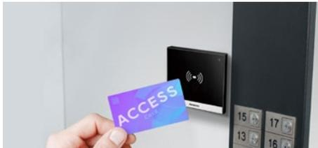
AV-A03 ist ein IP-basiertes Zutrittskontrollterminal, das einen Leser und einen Türcontroller kombiniert. Es bietet flexible Zugangsberechtigungen, darunter das Öffnen durch Winken über Bluetooth, mobilen Zugriff über NFC und RFID-Karten.
